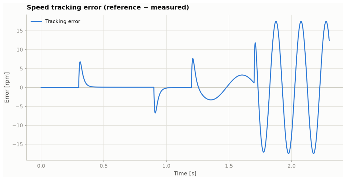
Fig. 11. Scénario B : erreur de suivi. L'échelle verticale rend visible ce que la figure 10 ne peut pas montrer.
